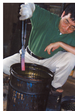
刃の切れ味を左右する焼き入れ
