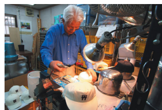
生地合わせ、マーク入れ、つばの縫い付けを経て、最後に型をつけて完成
