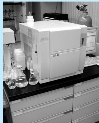
計画的に機器を更新し検査体制を強化しています(写真はTOC計)
