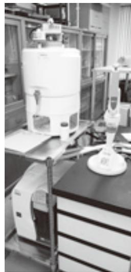
計画的に機器を更新し、検査体制を強化しています（写真は、超純水製造装置）
