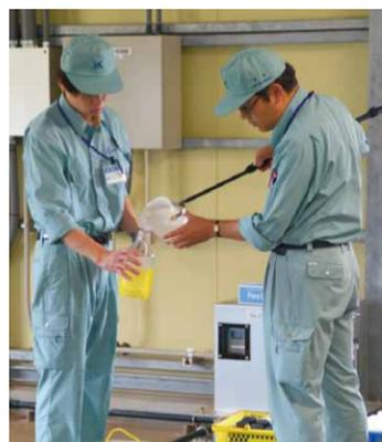
浄水場の採水の様子
