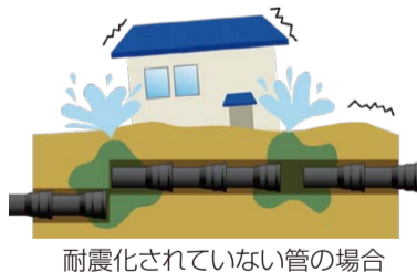
耐震化されていない管の場合
