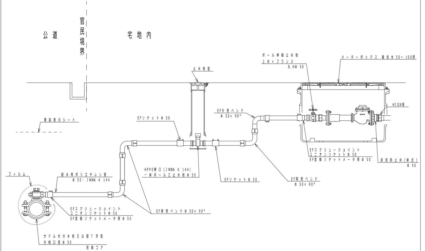
越谷・松伏水道企業団 標準配管図 口径 $\phi$  40 本管： 鋳鉄管
