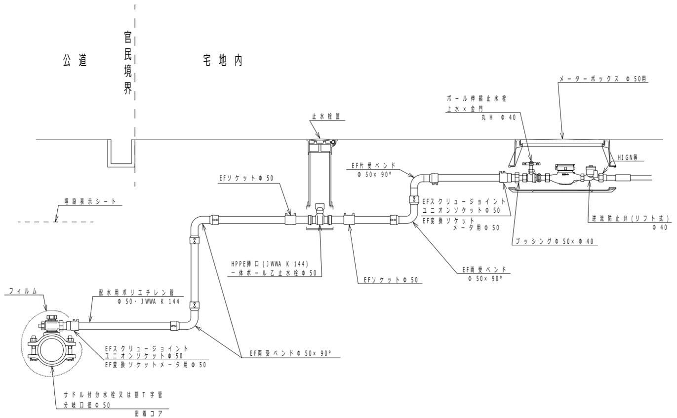
越谷・松伏水道企業団 標準配管図 口径 $\phi$  75 本管： 鋳鉄管
