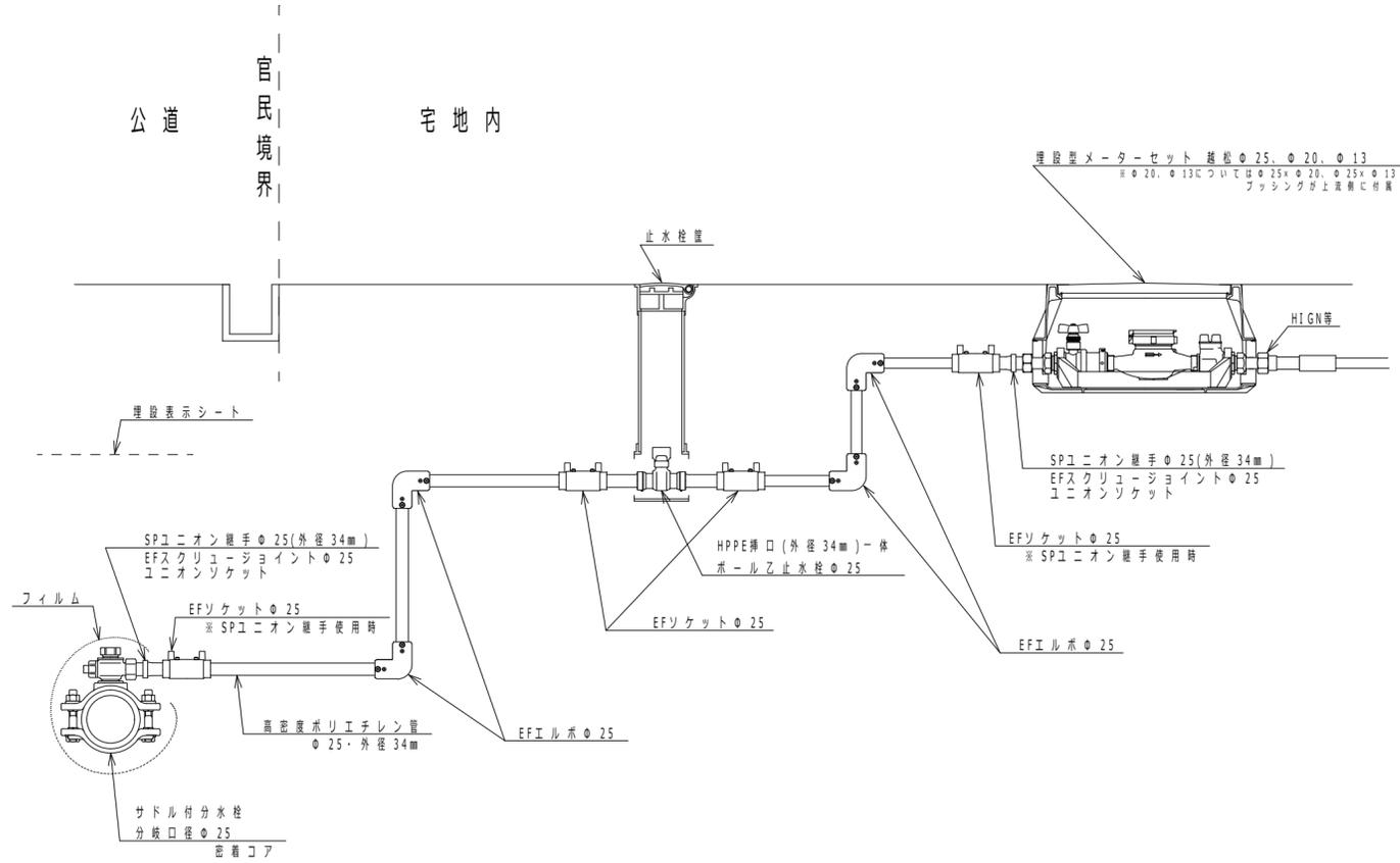
越谷・松伏水道企業団 標準配管図 口径 $\phi$  50 本管： 鋳鉄管
