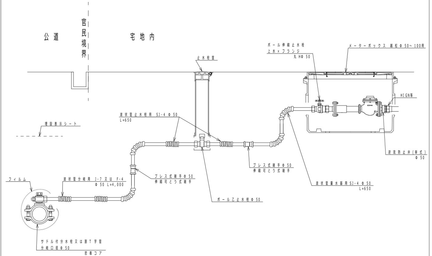
越谷・松伏水道企業団 標準配管図 口径 $\phi$ 40 本管：鑄鉄管
