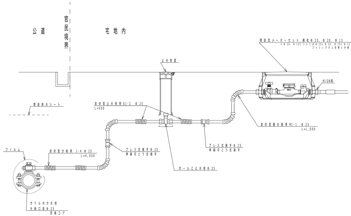
越谷・松伏水道企業団 標準配管図 口径 $\phi$ 50 本管：鑄鉄管
