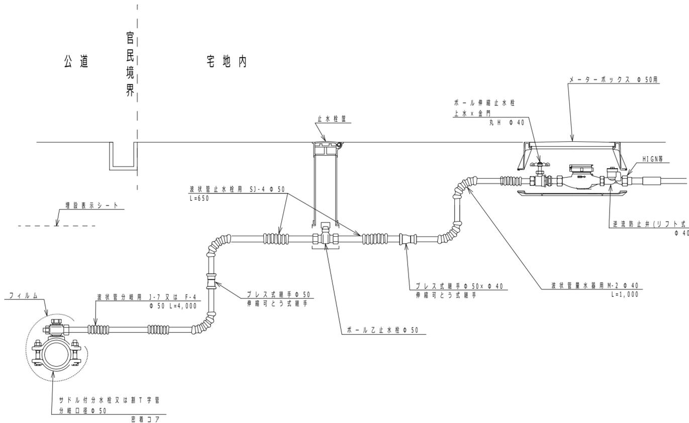
越谷・松伏水道企業団 標準配管図 口径 $\phi$ 75 本管：鑄鉄管
